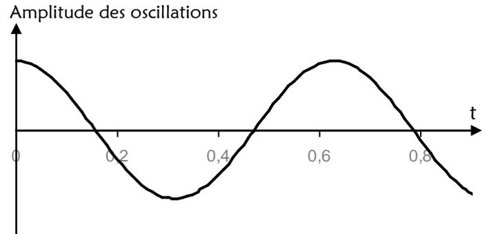
Cet oscillateur mécanique est appelé oscillateur harmonique car les oscillations sont sinusoïdales.
