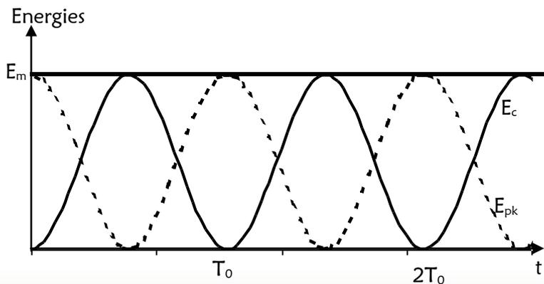
L'énergie mécanique se conserve : au cours du mouvement, il y a transformation d'énergie potentielle en énergie cinétique et vice versa.
